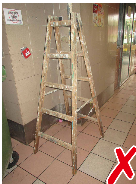
图 1：不安全的梯子
