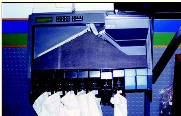
硬幣點算機的槽管若設有減震物料，有助減低硬幣點算過程中產生的噪音。
