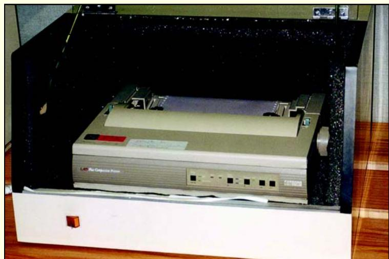
可安裝隔音裝置，以隔離產生噪音的設備，例如針孔打印機和舊式傳真機。
