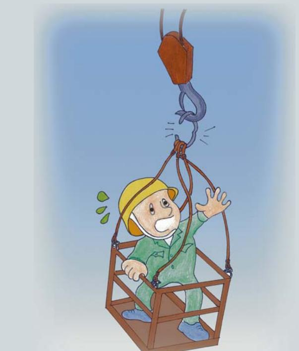
\* 「載人吊籠」繫在鋼板排頂時，被正在吊運中的鋼板樁擊中，引致倒塌
