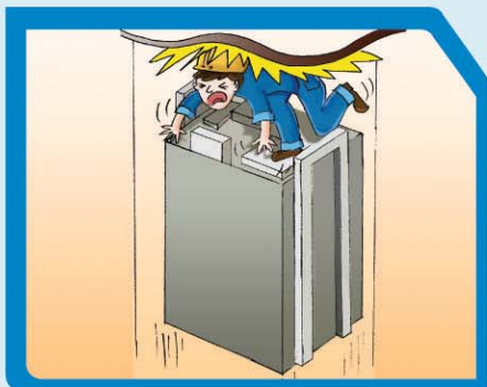
被夾於上升中的機廂與 升降機槽頂之間
