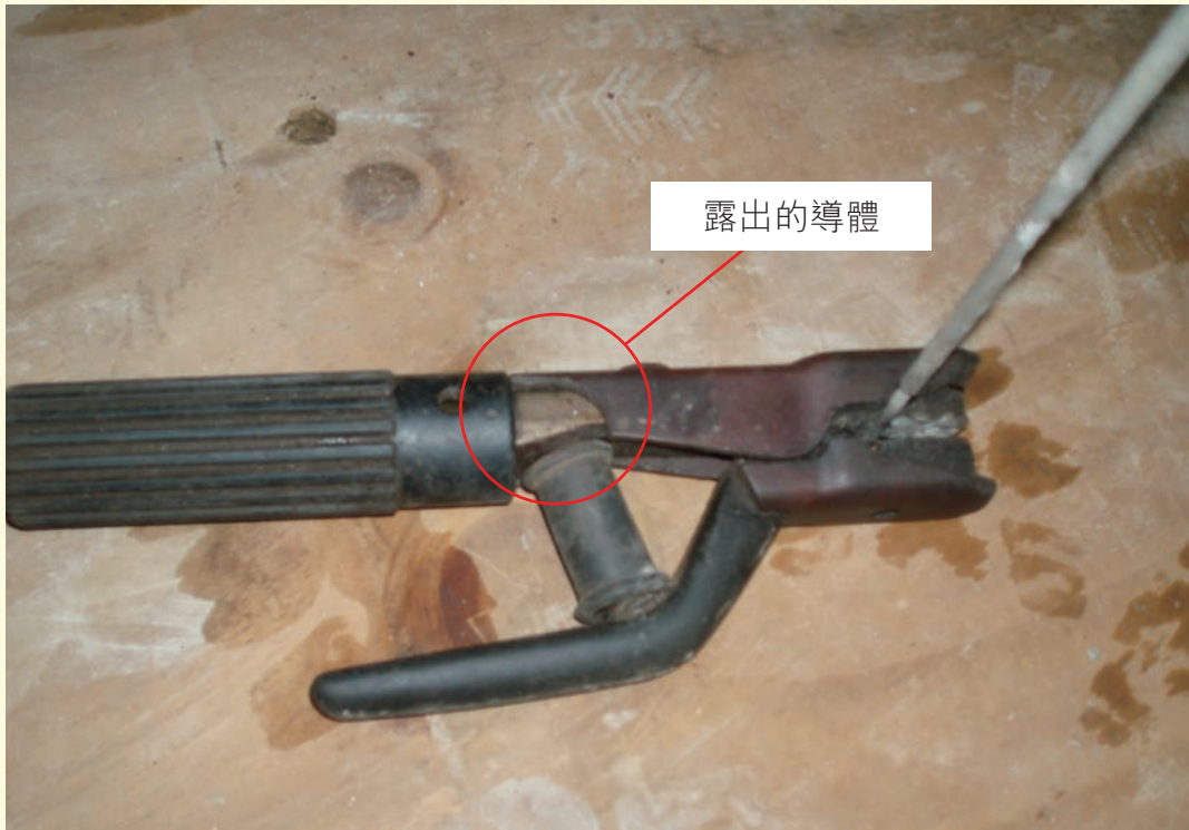
焊鉗絕緣物質損壞，露出導體
