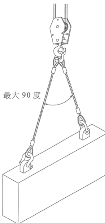
圖 13 兩條單支腳吊索以直接掛接法使用
