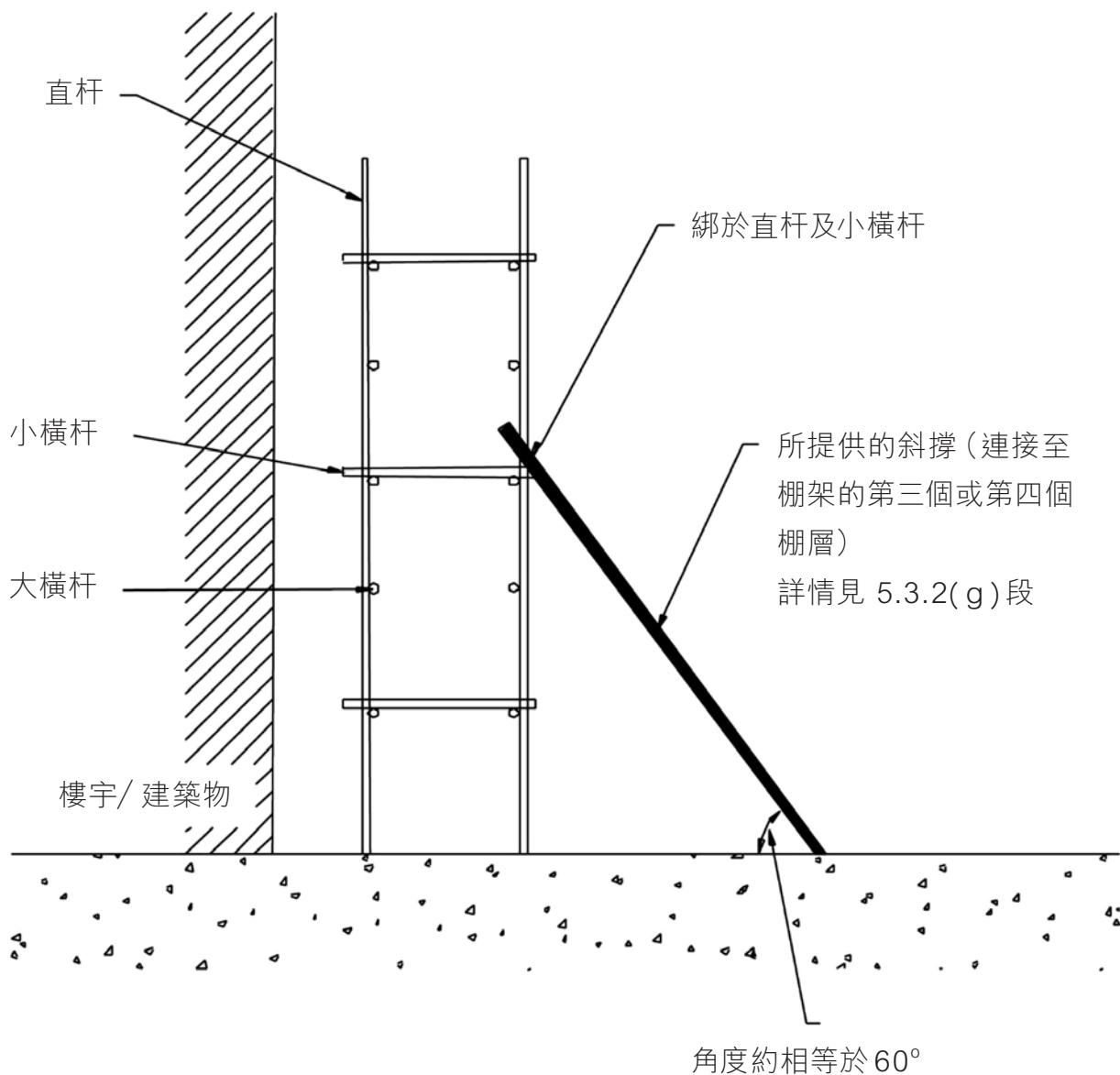
圖 7：架設竹棚架時，用作斜杆/ 斜撐、大橫杆、直杆的竹竿的正確連接方法（不按比例）
