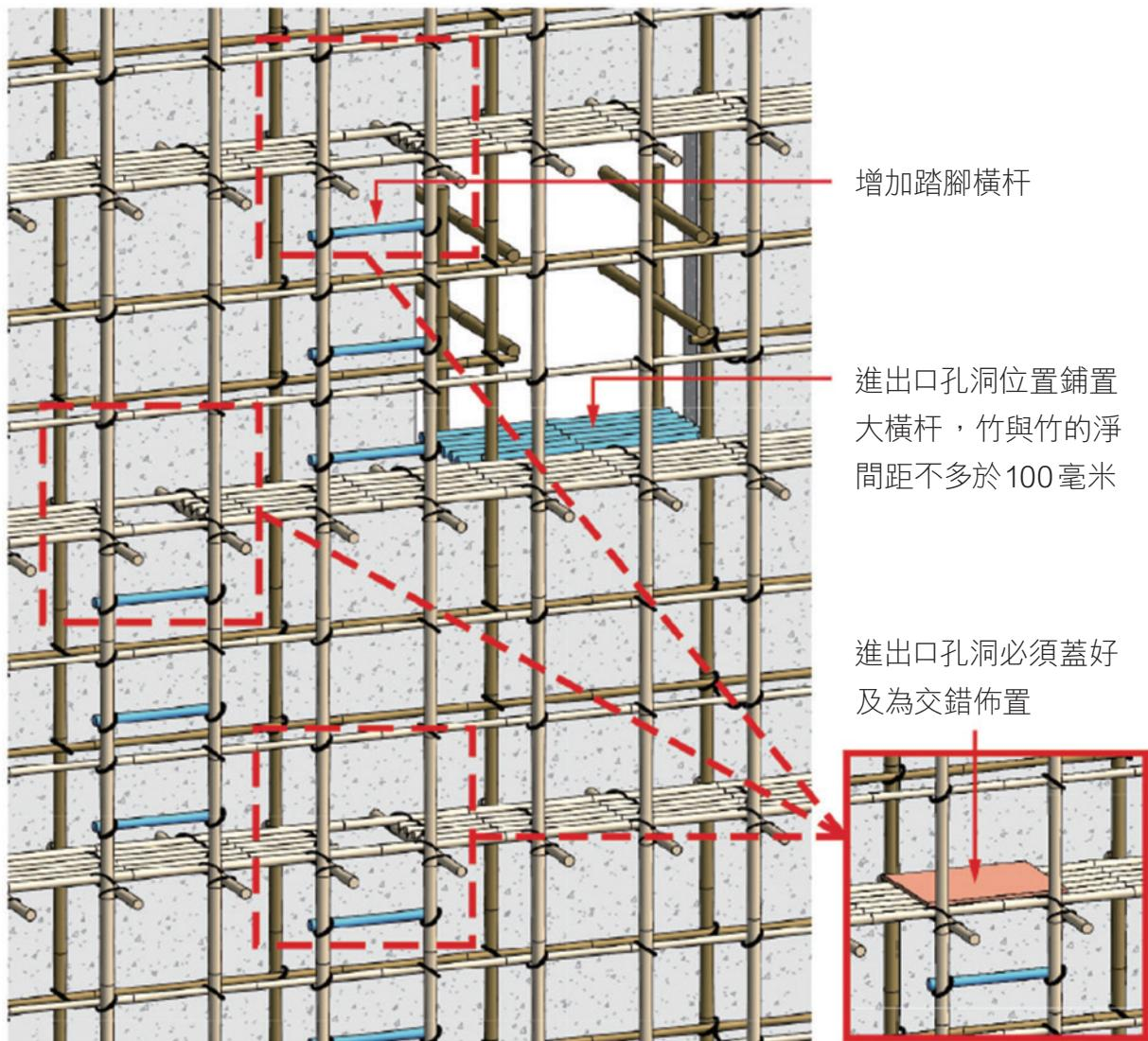
圖4：竹棚架連牆器及斜杆的位置（正面 — 不按比例）
