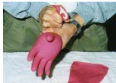
配戴防護手套前，要先測試手套有否破損，確保防護效能。
