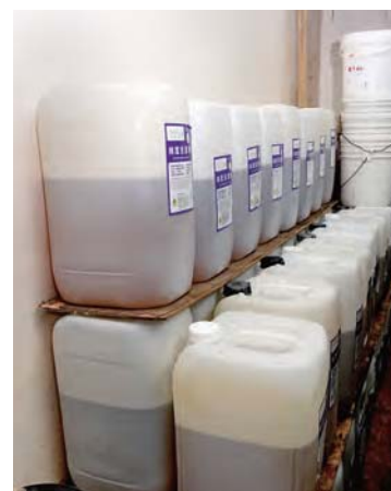
為了減低員工因搬運造成勞損的風險，將產品容器的注滿量大幅調低四分之一。
