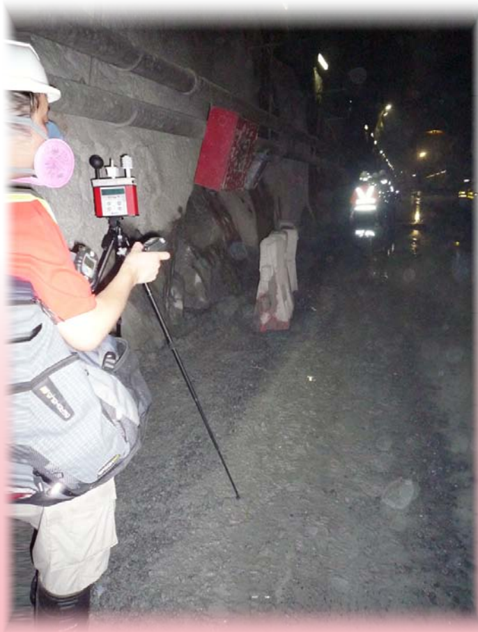
職業環境衛生師正在量度隧道地盤內的 空氣污染物和熱壓力水平
