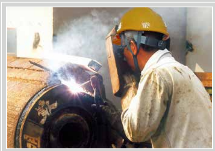
烧焊工序会产生烟气及有害气体。
