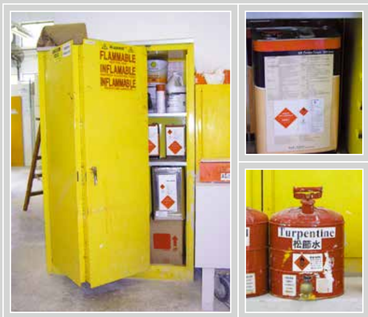
放置易燃物品的金属 贮存柜及容器
