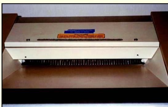
碎纸机内装有转动切刀，过大的入纸口足以让手指伸入，造成危害。职员操作碎纸机时，宽松的衣服及长发有可能被卷入并缠在转动切刀上。该危险部分应装上有效的护罩，如下图所示：
