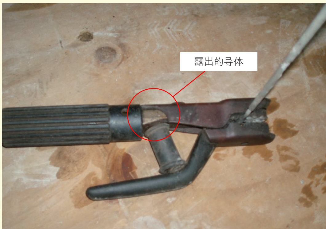
焊钳绝缘物质损坏，露出导体
