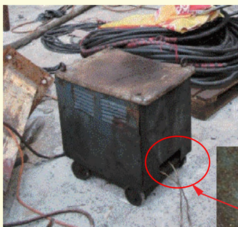
工人有机会触及外露的电线导体
