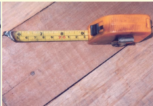
引起短路的拉尺金属部分
