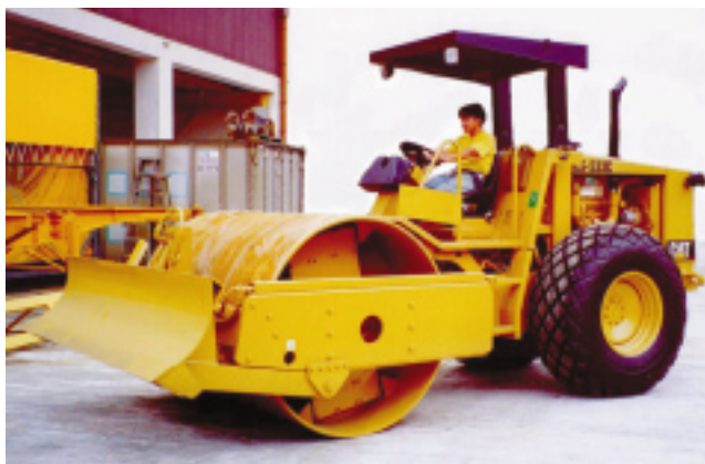
图 2 配备翻滚保护构件及安全带的负荷物移动机
