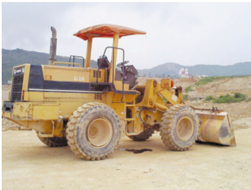
图 3 检查润滑油、液压油或冷却剂有否渗漏
