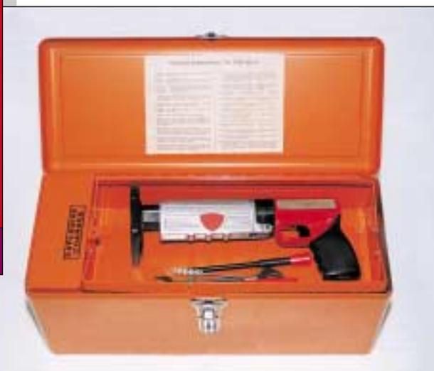
工具不用时，须拆除枪弹和钉，然后存放在适当的工具箱内，并加上锁。
