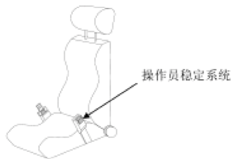
图三 装有操作员稳定系统的可调校座位
