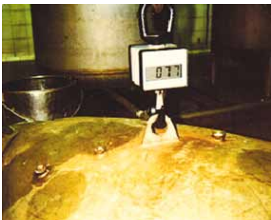
照片3.5 把压力煲盖量重， 以测定爆炸的压力
