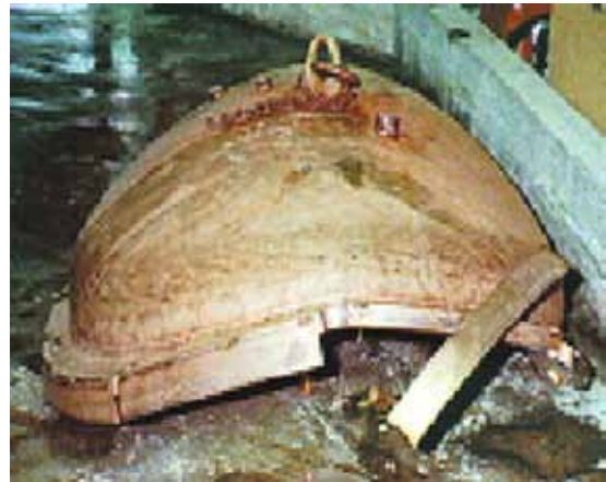
照片3.4 损毁的压力煲盖（不连配件）
