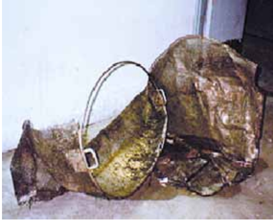
照片3.1 损毁的压力煲隔滤器
