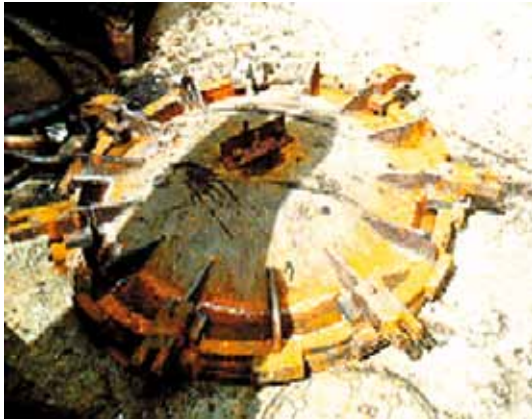
照片11.3 洗涤缸盖的接耳弯曲
