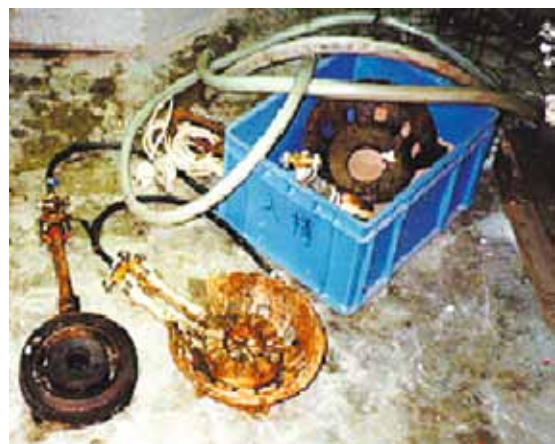
照片3.6 石油气炉
