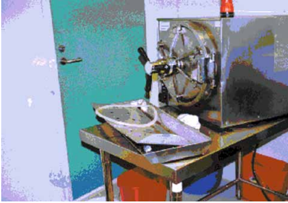
照片25.1 没有装上压力安全联锁的炉门
