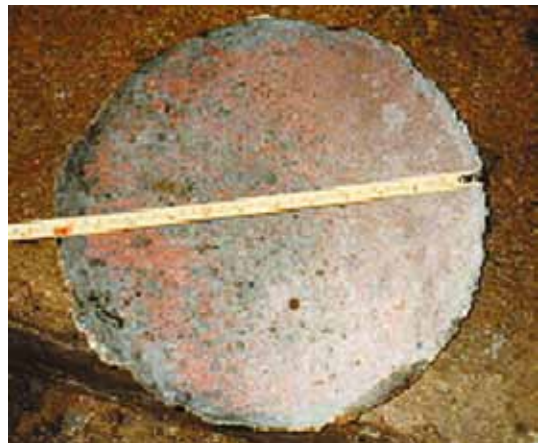
照片7.4 飞脱出来的蒸汽歧管端板
