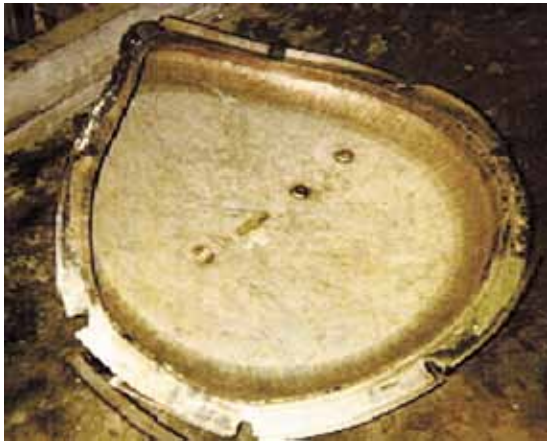
照片3.3 损毁的压力煲盖连配件
