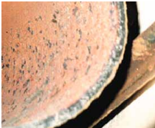
照片7.3 显示蒸汽歧管的爆裂边缘的近距离图
