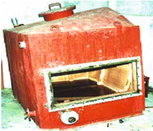
照片24.1 排污缸变形和爆裂
