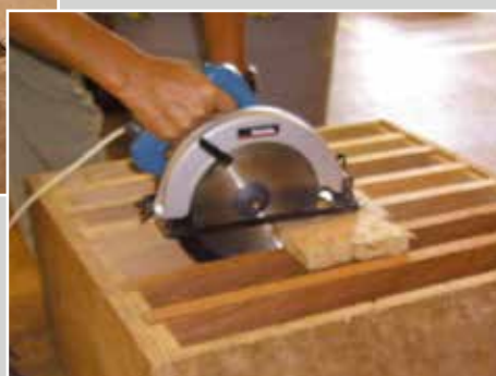
裝修工程用的手提電鋸連護罩及工件托架
