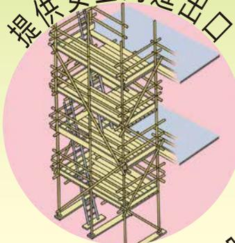
於樓邊設置穩固的護欄及底護板
