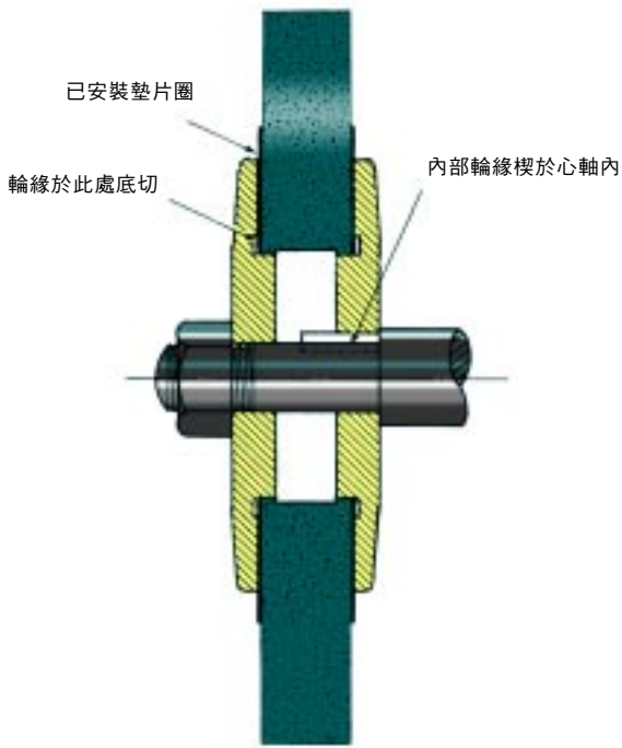
圖八：大孔的直邊砂輪
