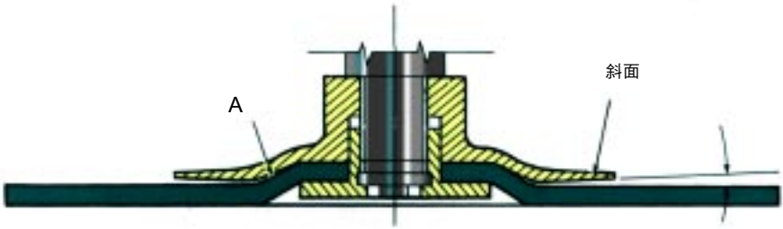
圖十二：安裝摺邊於中心下陷砂輪的方法，鄰近砂輪的摺邊外部地方應予削斜如圖所示，在“A”處，應留有一小空隙。
