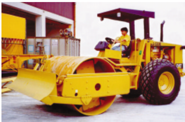
圖 2 配備翻滾保護構件及安全帶的負荷物移動機
