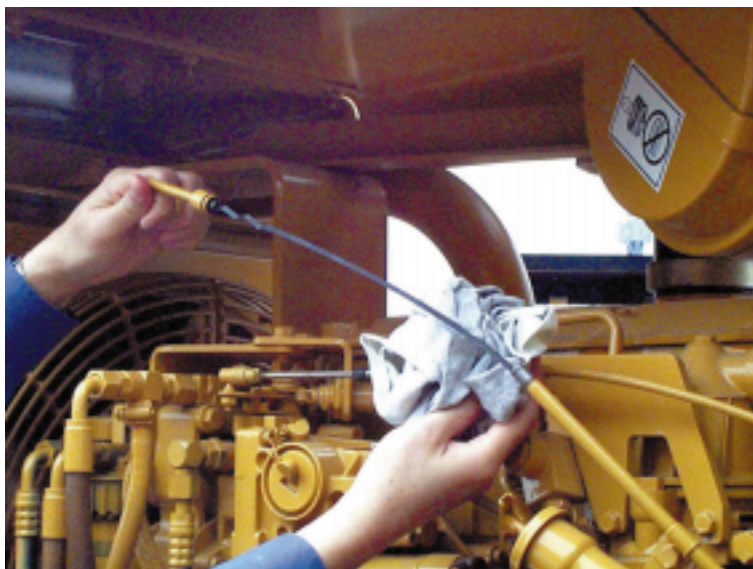
圖 4 檢查制動系統、傳動系統、動力轉向系統、引擎冷卻劑及液壓系統各種液體的水平
