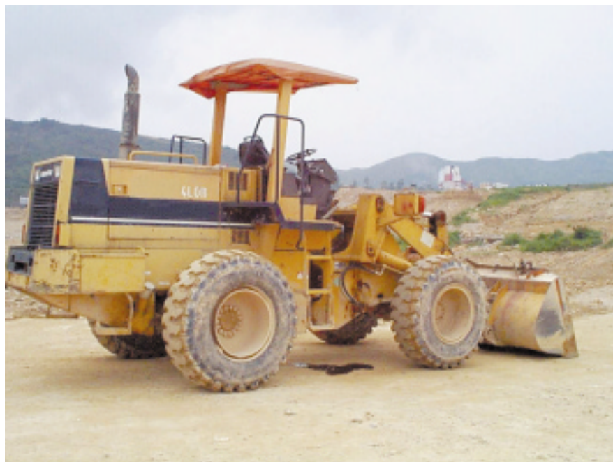
圖 3 檢查潤滑油、液壓油或冷卻劑有否滲漏
