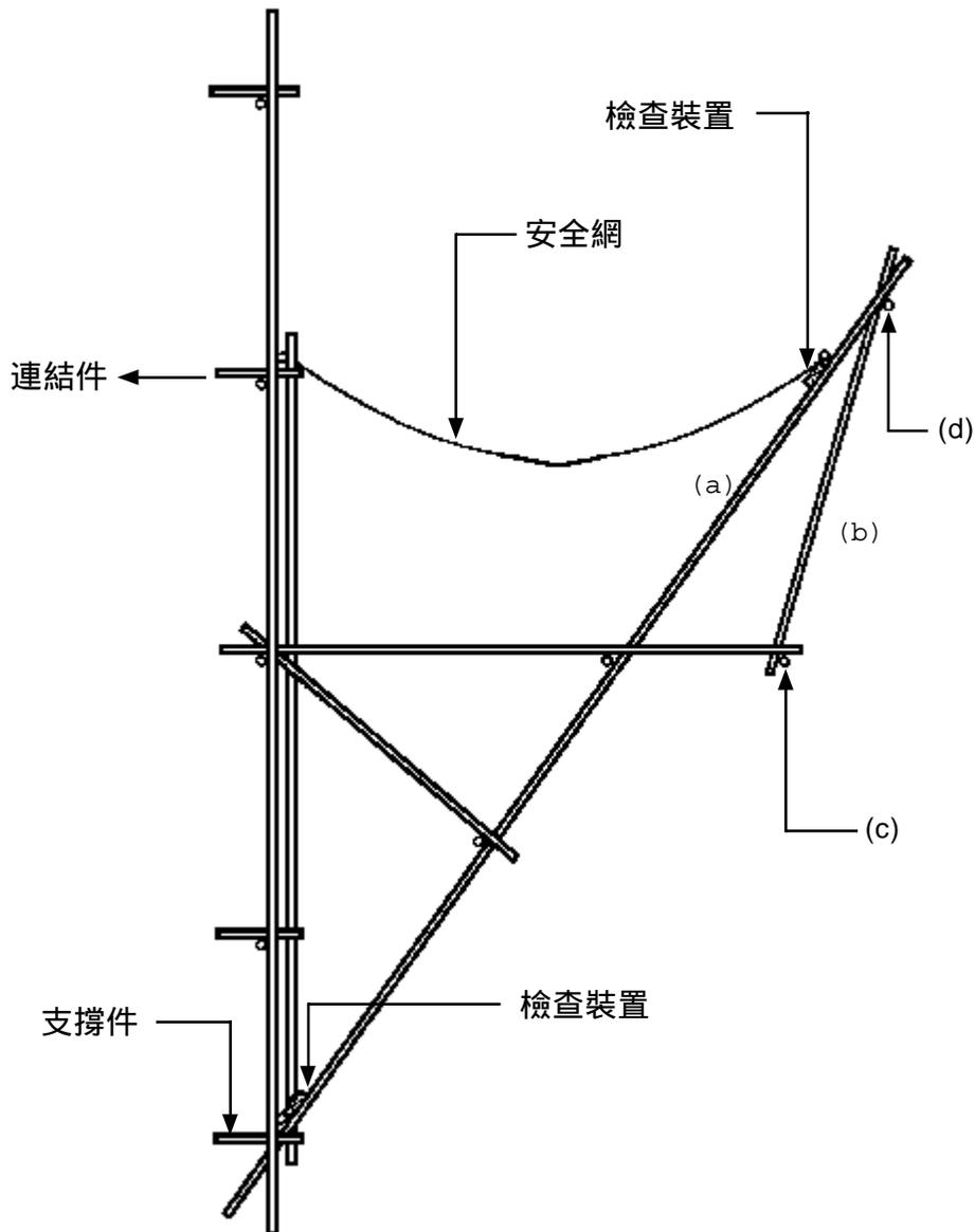
附註： (1) 安全網及其支承構架繫於棚架結構上，而棚架結構則該穩固地繫於建築物上。
