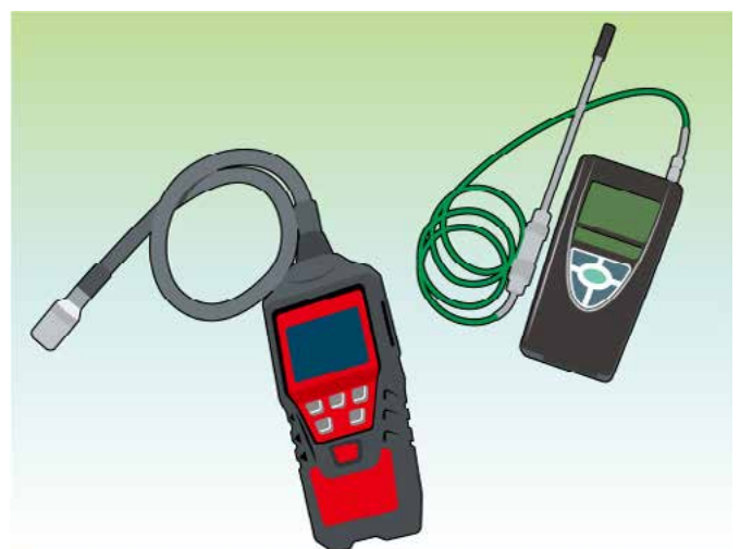
如要評估渠務工程潛在的空氣危害，可能需要使用多種空氣監測儀器
