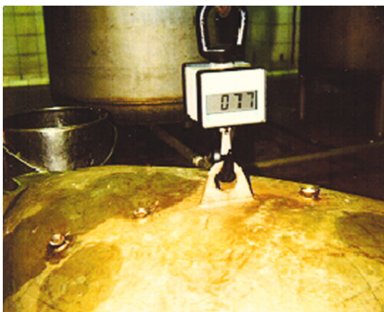
照片3.5 把壓力煲蓋量重， 以測定爆炸的壓力
