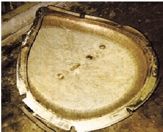
照片3.3 損毀的壓力煲蓋連配件
