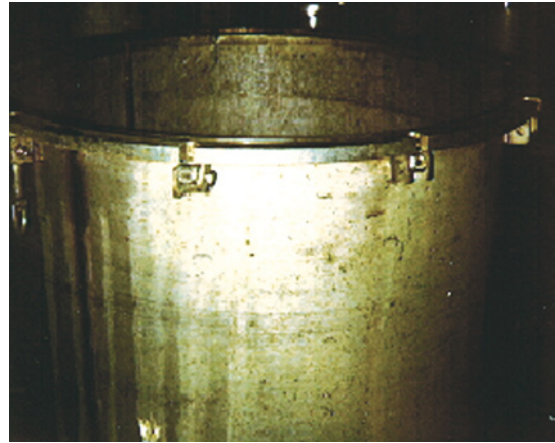
照片3.2 破裂的螺栓及軸套座
