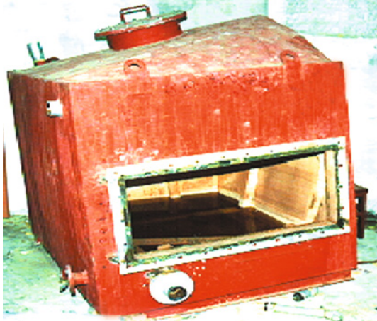
照片24.1 排污缸變形和爆裂
