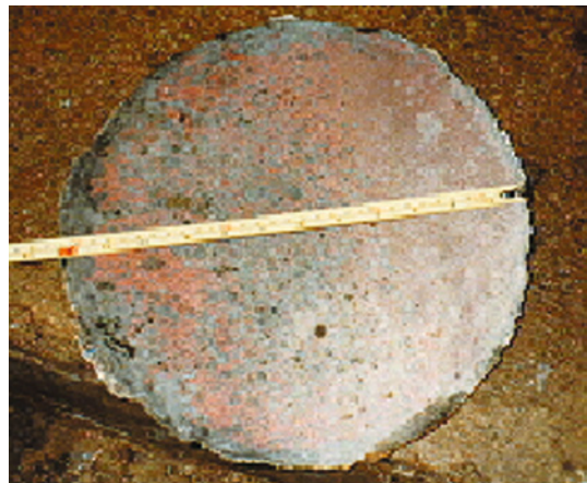
照片7.4 飛脫出來的蒸汽歧管端板
