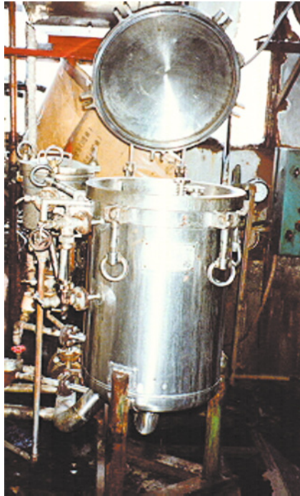
照片9.1 染紗缸的外貌和喉管
