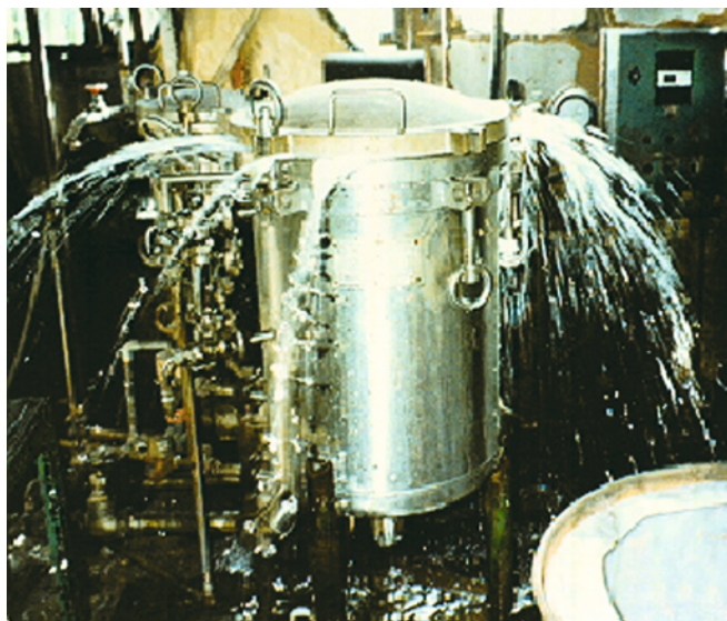
照片9.2 重演意外發生時水如何從染紗缸濺出
