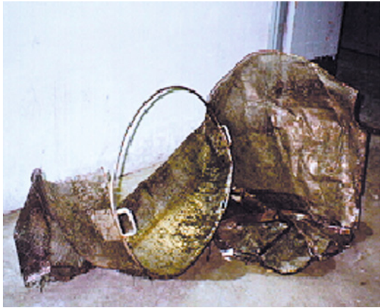
照片3.1 損毀的壓力煲隔濾器
