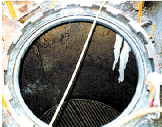
照片11.2 顯示蒸汽洗滌缸內部的近距離圖
