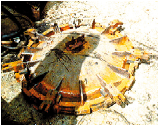
照片11.3 洗滌缸蓋的接耳彎曲
