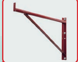
狗臂架必须装上最少三颗系稳螺丝
