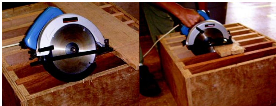
装修用手提电锯的护罩
