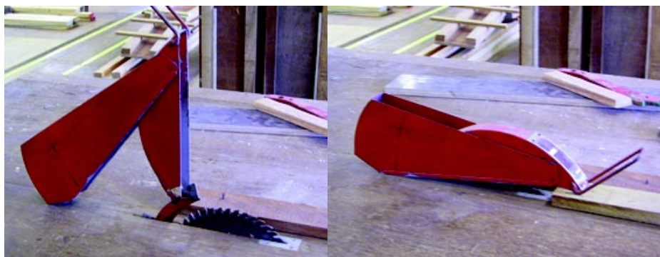
设有顶护罩连合格锯尾刀的装修用风车锯
