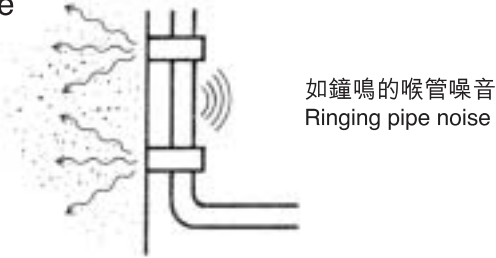
圖7 喉管發出的噪音 Figure 7 Pipe noise
