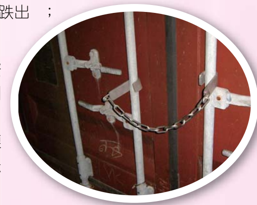
稳固货柜门的其中一种装置
