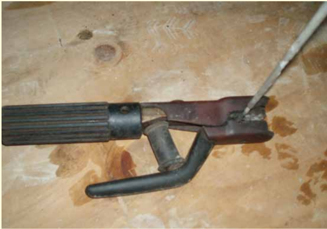
焊钳绝缘物质损坏，露出铜芯
