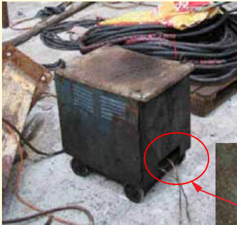
焊机的接线端子未被遮盖
