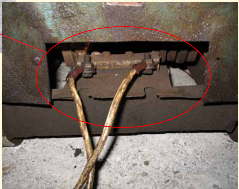
焊机的接线端子未被遮盖
