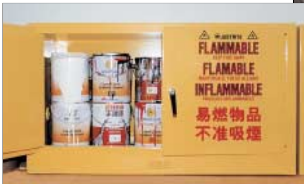
将易燃物品贮存于有掩门的金属箱内，该掩门应能自动关闭。
