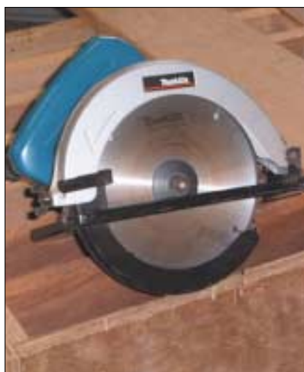
手提式风车锯应在设计上装有弹簧式的护罩,把大部分锯齿遮拦。
