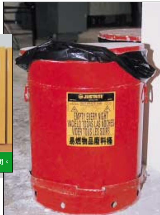
将沾有易燃物品的废料，弃置于有盖金属桶内，该盖应能自动关闭。
