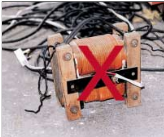
结构不良的电弧焊器具容易产生触电危险。
