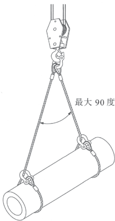
图 14 两条单支脚吊索以扼索结法使用
