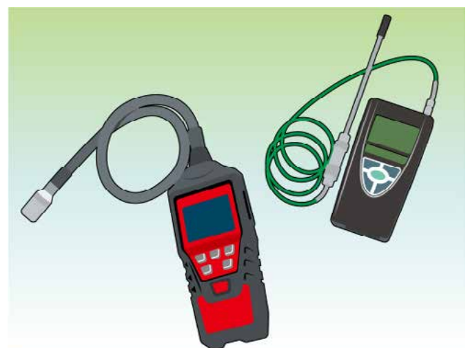
如要评估渠务工程潜在的空气危害，可能需要使用多种空气监测仪器
