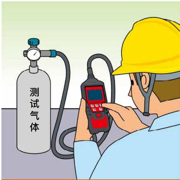
依照生产商的指示进行冲击测试
