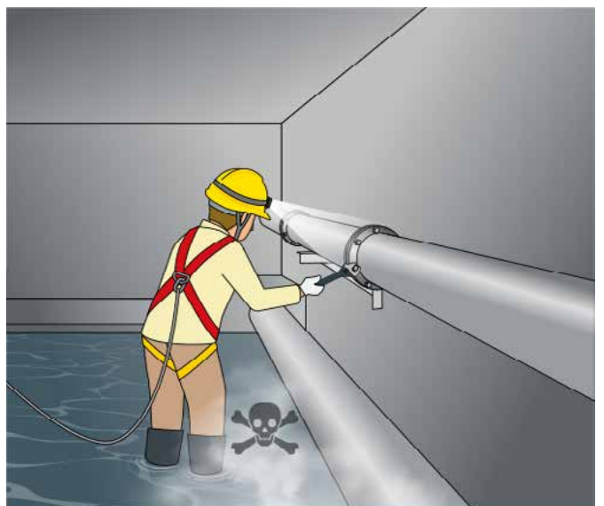
6. 忽视在通风不足的环境下进行渠务工作的危险
