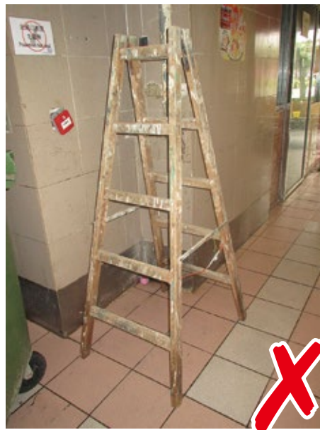
图 1：不安全的梯子
