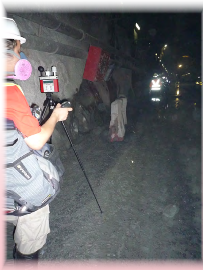
职业环境卫生师正在量度隧道地盘内的 空气污染物和热压力水平
