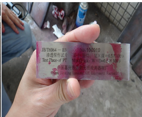
图2.7：染料渗透检验
